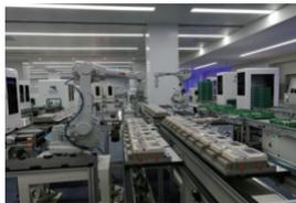
现场检定电能表流水线检定装置
