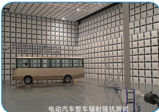
电动汽车整车辐射骚扰测试
