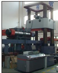
**30MN 压剪试验机 / 叠加式力标准机 0.1 级**
