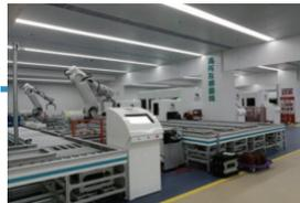
现场检定互感器流水线检定装置
