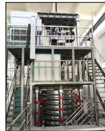
**500 kN 静重式力标准机及吊钩秤检定复合装置 0.01 级**
